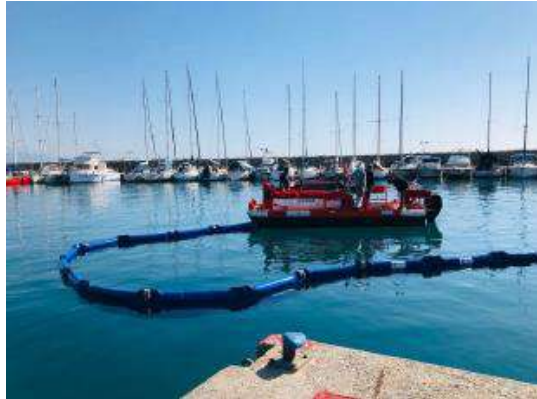
Figure 19 : Mise en place d'un dispositif de confinement par l'équivalent du bateau de servitude équipera la ZMO (source : Emergen'sea) Figure
