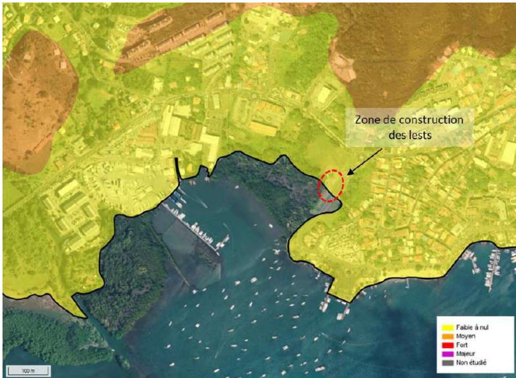
Figure 14 : Evaluation de l'aléa mouvement de terrain pour la zone de construction des lests
